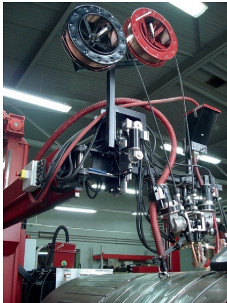
Saldature circonferenziali (serbatoi, ecc.)
