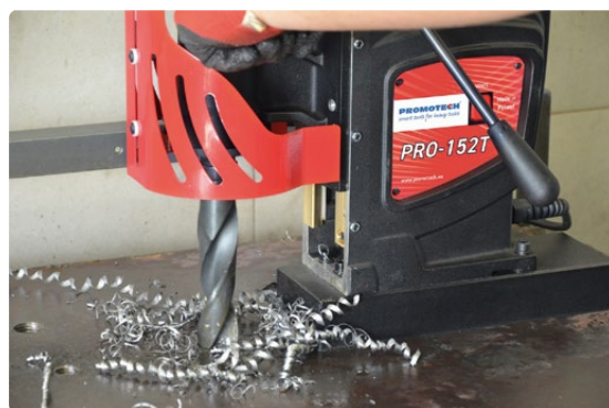
Foratura con punte elicoidali max 47 mm (1-7/8") Corsa 260 mm (10")
