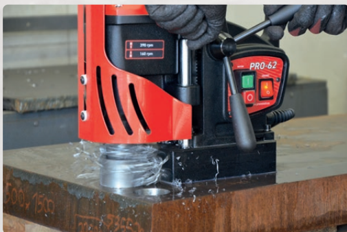
Capacità foratura con frese a corona sino a 65 mm (2-9/16")
